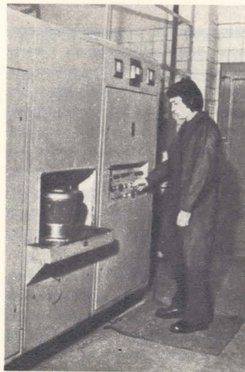
Традиционные инструменты гравера и чеканщика на этой стадии изготовления самовара не нужны. Простое нажатие кнопки — и в матрице готов корпус нового самовара.
